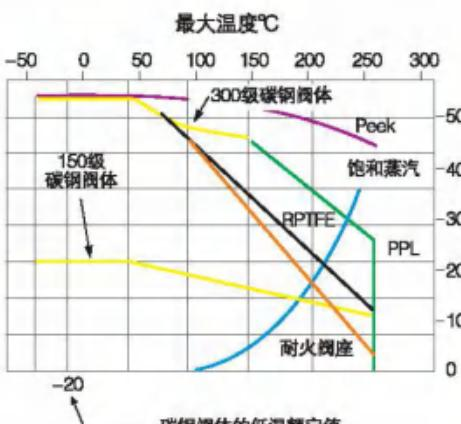
注意：316不锈钢或20号合金阀杆的14°–60°(DN350–1500)的150级阀门的最大压力差为150psi
