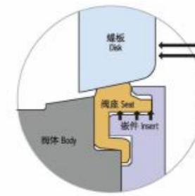
当嵌件侧受压时，压力被施加于唇缘的下方进一步加大了蝶板与阀座之间的密封力。
