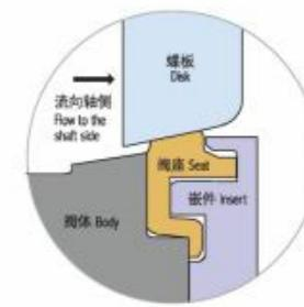
当压力施加于非嵌件的一侧时，蝶板被推向阀座。由于蝶板的轮廓呈球形，蝶板越向阀座推进，关闭就越紧密。唇缘与嵌件底部的槽接触，限制了阀座的过量移动。
