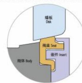
阀门关闭时蝶板使阀座稍稍变形，这一变形“激励”了阀座。阀座密封面的激励使它与蝶板的边缘保持持久的密封。
